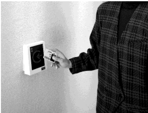
Bild 1.7: RFID-Lesegerät und kontaktlose Chipkarte im praktischen Einsatz. (Foto: Kaba Security Locking Systems AG, CH-Wetzikon)
