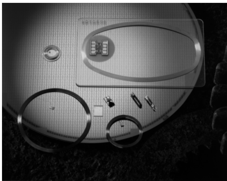
図3.13 様々なタイプの誘導結合トランスポンダ。この写真のものは、半完成のトランスポンダで、プラスチックのハウジングに収められる前の状態である。(AmaTech GmbH & Co. KG 提供)
