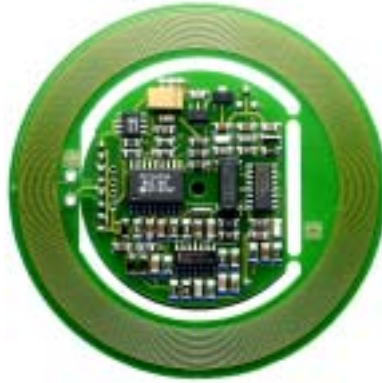
図3.14 稼働周波数 135 kHz のアンテナと統合された誘導結合トランスポンダ(easy-key System, micron 提供)
