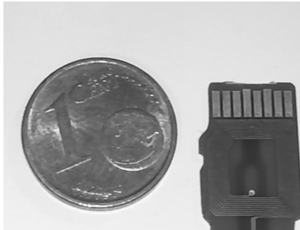
Abbildung 9: Größenvergleich – Transponderantenne in micro-SD Bauform
