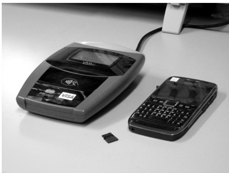
Abbildung 11: Zahlungsverkehrsterminal, Mobiltelefon und kontaktlose micro-SD Karte vor dem Einbau in das Telefon.
